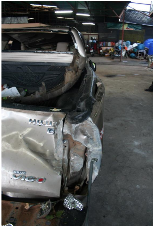
รูปที่ 3-5 แนวโครงสร้างที่บิดเบี้ยวของตัวรถหลังเกิดเหตุ
