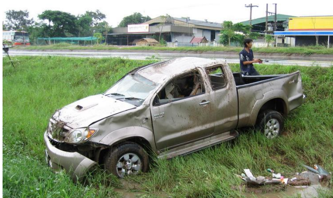
รูปที่ 3-3 สภาพความเสียหายของหลังคารถ
