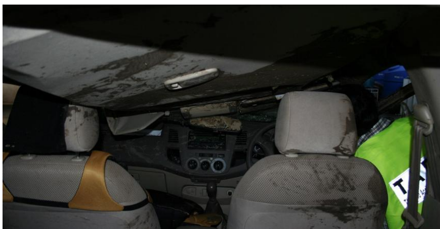
รูปที่ 3-12 สภาพหลังคาที่ยุบจากการพลิกคว่ำ
