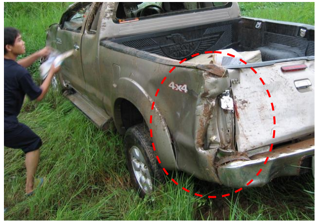
รูปที่ 3-10 หลักฐานการชนที่คันดินบริเวณเสาไฟฟ้า
