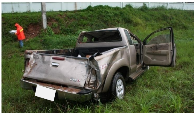
รูปที่ 3-4 สภาพความเสียหายตอนท้ายของรถ
