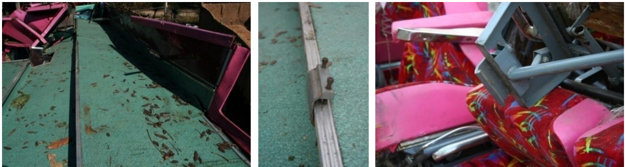
รูปที่ 3-19 เบาะที่นั่งหลุดออกจากจุดยึด กรณีอุบัติเหตุรถโดยสารพลิกคว่ำ 19 มกราคม พ.ศ.2550
