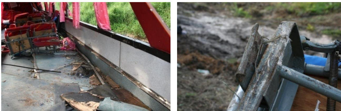
รูปที่ 3-20 เบาะที่นั่งหลุดออกจากจุดยึด กรณีอุบัติเหตุรถโดยสารพลิกคว่ำ 10 ตุลาคม พ.ศ.2551
