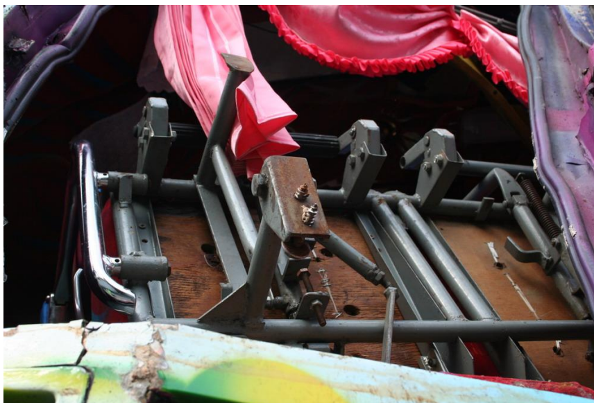
รูปที่ 3-11 จุดยึดของเบาะที่นั่งชั้นล่างซึ่งหลุดจากพื้นรถ
