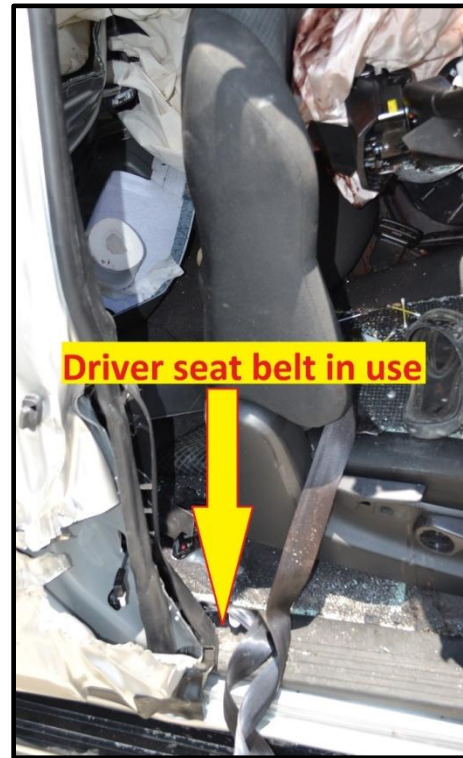
รูปที่ 15 หลักฐานการใช้เข็มขัดนิรภัยของผู้ขับขี่ และผู้โดยสารข้างผู้ขับขี่
