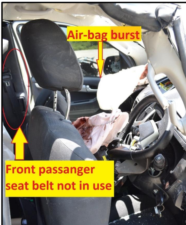
รูปที่ 15 หลักฐานการใช้เข็มขัดนิรภัยของผู้ขับขี่ และผู้โดยสารข้างผู้ขับขี่
