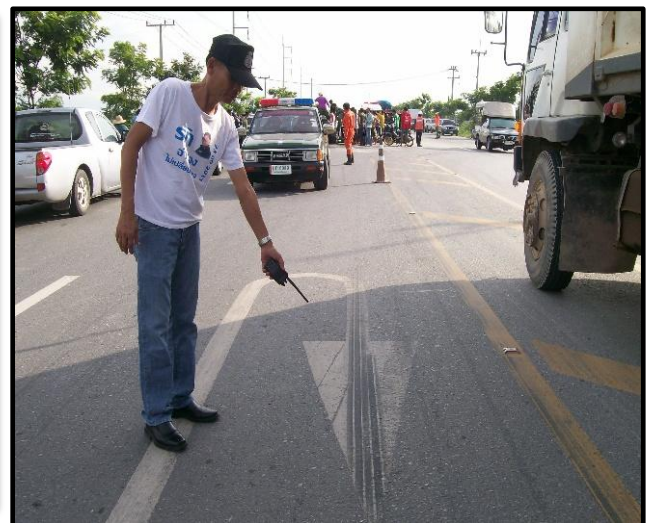
รูปที่ 11 ภาพลำดับเหตุการณ์ที่บันทึกได้จากกล้องวงจรปิดในที่เกิดเหตุ และร่องรอยเบรคบนผิวถนน
