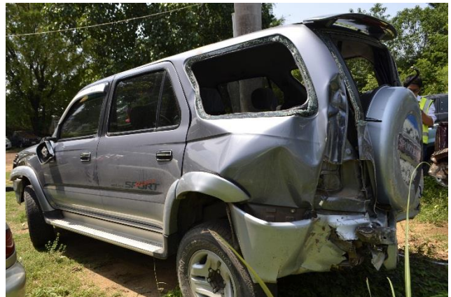
รูปที่ 19 สภาพความเสียหายของรถยนต์อเนกประสงค์ (V3)
