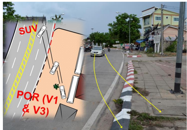
รูปที่ 36 เส้นทางการเคลื่อนที่ของรถยนต์อเนกประสงค์หลังชน (Post-crash)
