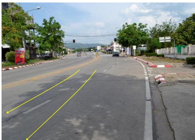
รูปที่ 36 เส้นทางการเคลื่อนที่ของรถยนต์อเนกประสงค์หลังชน (Post-crash)
