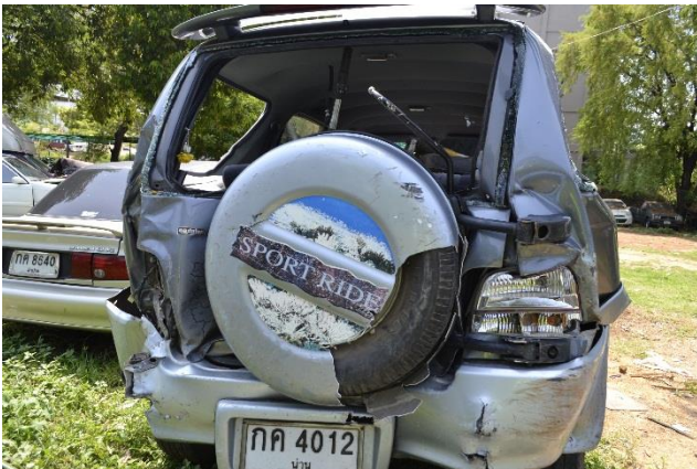
รูปที่ 19 สภาพความเสียหายของรถยนต์อเนกประสงค์ (V3)
