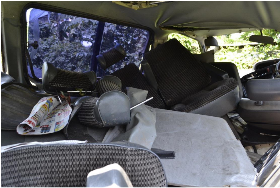
รูปที่ 12 เบาะที่นั่งหลุดออกจากจุดยึดและกระจายอยู่ภายในรถตู้
