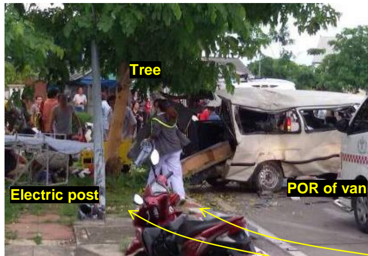
รูปที่ 32 สภาพความเสียหายของเสาไฟและต้นไม้ และจุดสุดท้าย (POR) ของรถตู้
