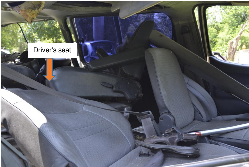
รูปที่ 13 หลักฐานแสดงการใช้เข็มขัดนิรภัยบริเวณที่นั่งคนขับ
