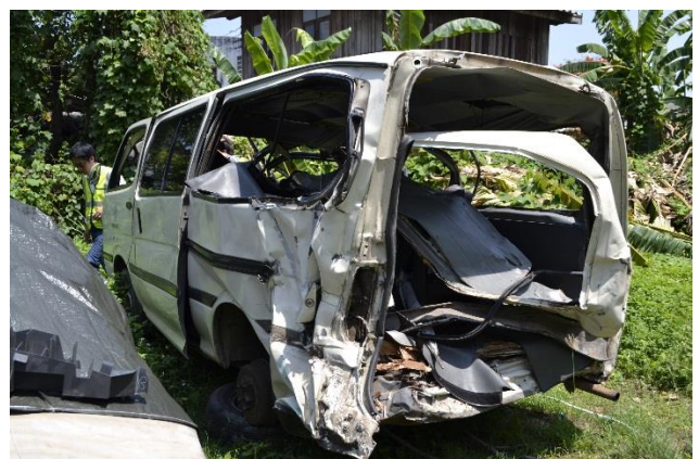
รูปที่ 15 สภาพความเสียหายของรถตู้
